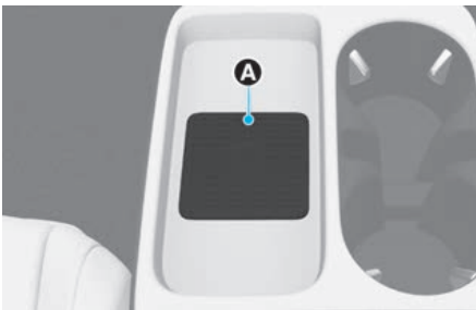
[A] Panel de autenticación del vehículo (base de carga inalámbrica)
