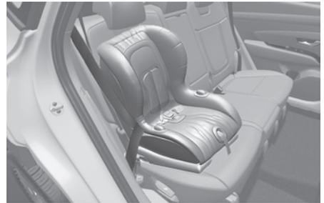
1. Guíe la correa superior del sistema de sujeción para niños sobre el respaldo. Al colocar la correa superior, siga las instrucciones del fabricante del sistema de sujeción para niños.
