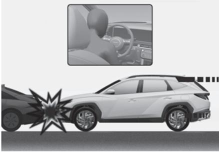
En algunas colisiones a baja velocidad, los airbags podrían no desplegarse. Los airbags están diseñados para no desplegarse en esos casos porque no aportarían beneficios adicionales a la protección ofrecida por el cinturón de seguridad.
