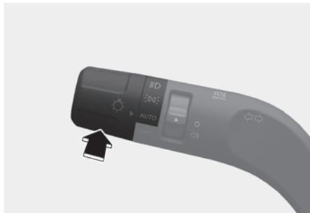
Para encender las luces largas, empuje la palanca hacia delante. La palanca vuelve a su posición original.
