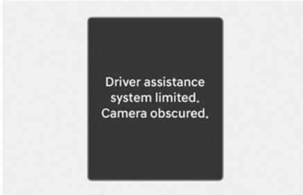
Si el parabrisas delantero donde está ubicada la cámara de visión frontal o el sensor están cubiertos por sustancias extrañas, como nieve o lluvia, puede reducirse el rendimiento de detección y limitarse de forma temporal o deshabilitarse la asistencia de prevención de colisión frontal.
