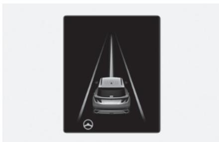
Si se detecta el vehículo que circula por delante o ambas marcas de carril y la velocidad de su vehículo es inferior a 180 km/h (112 mph), el indicador verde (Ⓢ), y el asistente de seguimiento de carril ayuda a centrar el vehículo en el carril asistiendo al volante.
