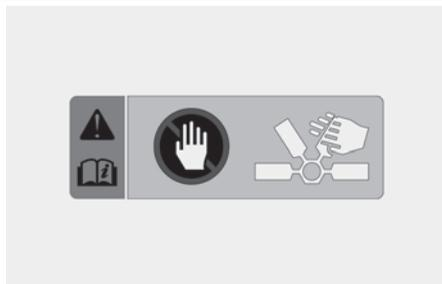
No aproxime la mano al ventilador de refrigeración en el compartimento del motor mientras está cargando. Puede funcionar automáticamente para controlar la temperatura de la batería, incluso si el vehículo está apagado.
