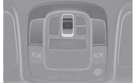
El techo solar sólo puede funcionar cuando el botón de arranque/parada del motor está en la posición ON o START.
