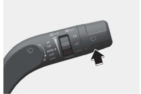
Empuje la palanca hacia delante para pulverizar líquido limpiaparabrisas en la luneta trasera y accionar los limpiaparabrisas 1-3 ciclos. El funcionamiento del pulverizador y del limpiaparabrisas continúa hasta que suelte la palanca.
