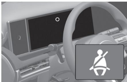
Como recordatorio para el conductor, los testigos de advertencia del cinturón del asiento del conductor se iluminan durante aproximadamente 6 segundos cada vez que coloca el interruptor de encendido en ON sin tener en cuenta si el cinturón está o no abrochado.
