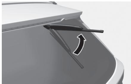
1. En los 20 segundos siguientes al apagado del vehículo, pulse el interruptor del limpiaparabrisas en la posición MIST durante unos 2 segundos hasta que los limpiaparabrisas se muevan a la posición más baja.
