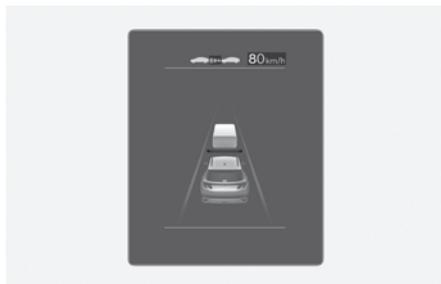
Si desea acelerar temporalmente sin alterar la velocidad establecida mientras el control de crucero inteligente está en funcionamiento, pise el pedal del acelerador. Mientras se pisa el pedal del acelerador, la velocidad establecida, el nivel de distancia y la distancia objetivo parpadearán en el tablero.
