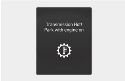
La aceleración brusca y repetida, y el arranque rápido pueden sobrecalentar la transmisión. Si la transmisión se sobrecalienta, el modo de autoprotección avisa al conductor con un mensaje de advertencia con sonido acústico.
