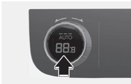
En modo automático, pulse el botón AUTO para seleccionar la velocidad del ventilador del nivel 1 al 3.
