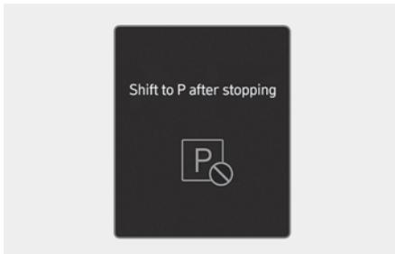
Este mensaje aparece cuando se cambia la marcha a P (estacionamiento) con el vehículo en movimiento. Detenga el vehículo antes de cambiar a P (estacionamiento).
