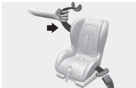
4. Tire del sistema de sujeción para niños para confirmar que el cinturón de seguridad lo sujeta firmemente.
