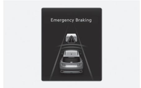
Para avisar al conductor de que la frenada de emergencia será asistida, el mensaje de advertencia "**Frenado de emergencia**" aparecerá en el tablero, se emitirá un sonido de advertencia y el volante vibrará (si está equipado).
