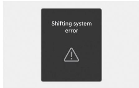
Este mensaje aparece cuando la transmisión o el selector de cambios no funcionan correctamente en la posición P (estacionamiento).
