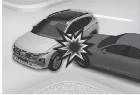
Los airbags delanteros podrían no inflarse en colisiones de impacto lateral porque los ocupantes se mueven en la dirección de la colisión; es decir, en los impactos laterales, el despliegue del airbag delantero no ofrecería ninguna protección adicional.
