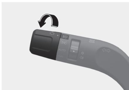
Los faros, la luz de posición, la luz de la matrícula y la luz del panel de instrumentos se encienden.
