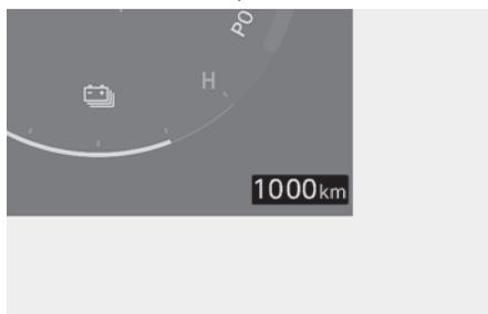
El cuentakilómetros indica la distancia total que ha circulado el vehículo y debe usarse para determinar cuándo debe realizarse el mantenimiento periódico.
