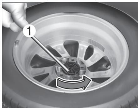
Si resulta difícil aflojar el perno de palomilla de fijación de la rueda con la mano, puede aflojarlo más fácilmente usando la palanca de maniobra del gato.
