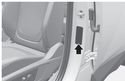
La etiqueta de certificación del vehículo situada en la columna central en el lado del conductor (o del pasajero delantero) muestra el número de identificación del vehículo (VIN).
