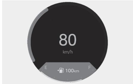
El velocímetro indica la velocidad del vehículo y está calibrado en kilómetros por hora (km/h) y/o millas por hora (MPH).
