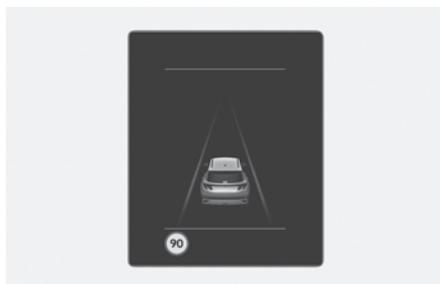
La información del límite de velocidad se muestra en el tablero de instrumentos.
