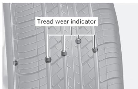
Si el neumático se desgasta de forma irregular, aparecerá un indicador de desgaste de la banda de rodadura en forma de banda sólida a lo largo de la banda de rodadura. Esto indica que quedan menos de 1,6 mm (1/16 pulg.) de banda de rodadura en el neumático. Cambie el neumático cuando suceda esto.
