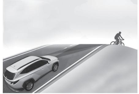
La asistencia de prevención de colisión frontal puede no detectar otros vehículos, vehículos de dos ruedas con motor, peatones o ciclistas por delante al subir o bajar por carreteras en pendiente que afecten negativamente al rendimiento de los sensores.
