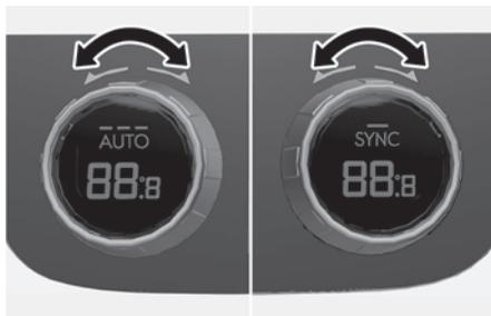
3. Le recomendamos que utilice el botón AUTO (control automático) para mantener un aire interior agradable, independientemente de la estación del año. Normalmente, ajuste la temperatura a 22 °C. El botón AUTO (control automático) no se iluminará cuando seleccione las siguientes funciones. La función seleccionada de las siguientes se activará mientras el sistema AUTO permanezca en funcionamiento.
