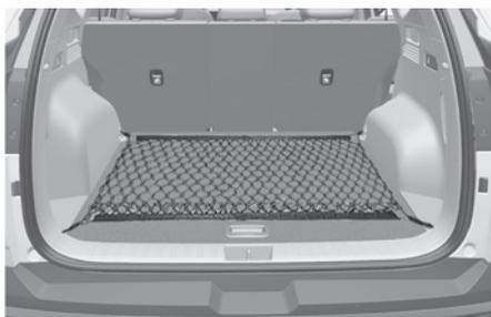
Para evitar que se desplacen objetos en el maletero, utilice las 4 anillas allí dispuestas para sujetar la red de carga.
