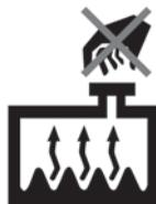
No extraiga nunca el tapón de refrigerante del motor y/o el tapón de refrigerante del inversor o el tapón de drenaje mientras el motor y el radiador estén calientes. Podría salir refrigerante o vapor caliente a presión y causar lesiones graves.
