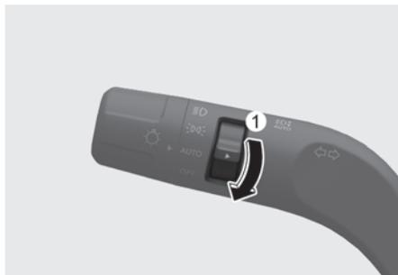
Para encender la luz antiniebla trasera: Coloque el interruptor de los faros en la posición de faros y, a continuación, gire el interruptor de los faros (1) a la posición de luz antiniebla trasera.
