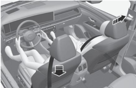
El vehículo viene equipado con cinturones con pretensores (pretensor retractor) en el asiento del conductor, del pasajero delantero y de los pasajeros traseros. La finalidad del pretensor es garantizar que los cinturones de seguridad se ajusten firmemente al cuerpo del ocupante en determinadas colisiones frontales o laterales. Los pretensores del cinturón de seguridad pueden activarse en colisiones, junto con los airbags, cuando la colisión frontal o lateral sea lo bastante fuerte.
