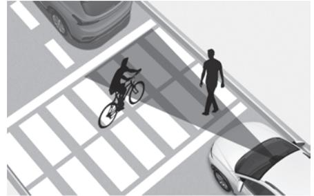
Si hay peatones o bicicletas entre usted y el vehículo que le precede, es posible que el aviso de movimiento del vehículo de delante no funcione correctamente.
