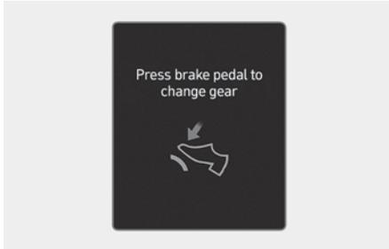
Este mensaje aparece cuando no se pisa el pedal del freno al cambiar de marcha. Pise el pedal del freno y, a continuación, cambie la marcha.
