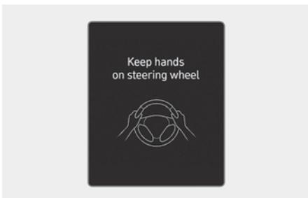
Si el conductor retira las manos del volante durante varios segundos, aparecerá el mensaje de advertencia «**Mantenga las manos en el volante**» y se emitirá un sonido de advertencia por fases.
