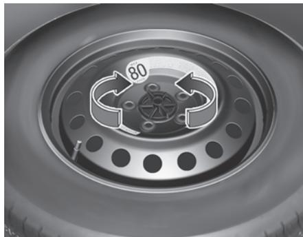
Gire el perno de palomilla de fijación en sentido antihorario para extraer el neumático de repuesto.
