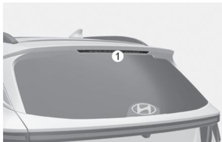
Si la luz LED (1) no funciona, recomendamos que haga inspeccionar el sistema por un distribuidor HYUNDAI autorizado.
