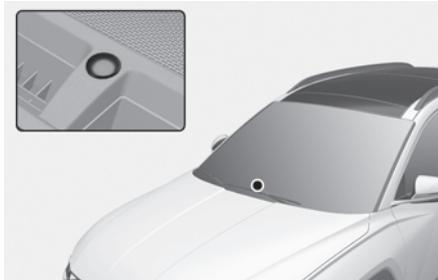
Este vehículo está equipado con un sensor de radiación solar situado en la parte superior del salpicadero. Con el aire acondicionado en AUTO, el sensor detectará la radiación solar y ajustará la temperatura interior automáticamente. Evite colocar cualquier objeto sobre el sensor de radiación solar para el control de la temperatura interior.
