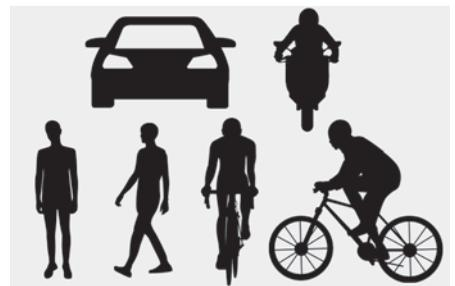
La ilustración anterior muestra la imagen que la cámara de visión frontal y el radar delantero son capaces de detectar como vehículo, vehículo de dos ruedas con motor, peatón y ciclista.
