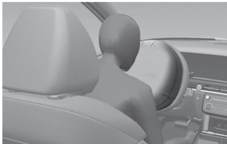
Cuando el SRSCM detecta un impacto fuerte en la parte delantera del vehículo, se desplegarán automáticamente los airbags delanteros.
