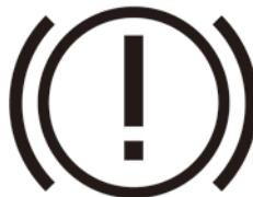
Compruebe el testigo de advertencia del freno de estacionamiento girando el botón ENGINE START/STOP (inicio/parada del motor) a ON.
