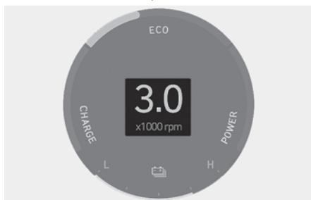
El tacómetro indica el número aproximado de las revoluciones del motor por minuto (RPM).
