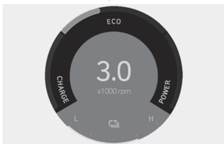
El indicador de potencia indica si el estado de conducción actual conlleva un ahorro eficiente del combustible o no.
