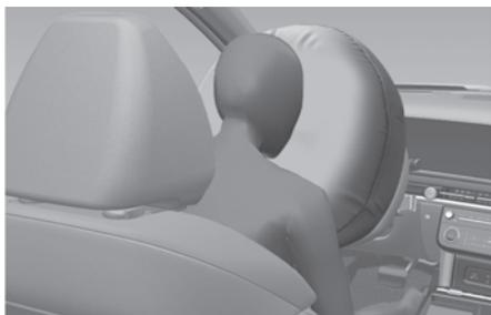
Una vez desplegados, las costuras moldeadas directamente en las cubiertas del panel se separarán por la presión de la expansión de los airbags. Esta mayor apertura de las cubiertas es lo que permite el completo inflado de los airbags.
