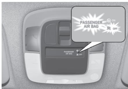
Introduzca la llave o un dispositivo rígido similar en el interruptor ON/OFF del airbag delantero del pasajero y gírelo a la posición OFF. El indicador de desactivación del airbag del acompañante (☹️) se ilumina y permanece encendido hasta que se reactive el airbag delantero del acompañante.
