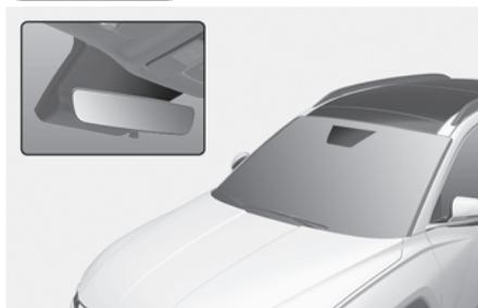
El sistema de desempañado automático reduce la posibilidad de empañado en el interior del parabrisas al detectar automáticamente la humedad del interior del parabrisas.
