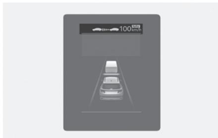
Aparece el estado de funcionamiento actual del asistente manual de limitación de velocidad, el control de crucero inteligente, el asistente de seguimiento de carril, etc.
