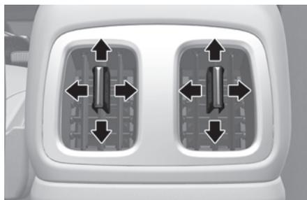
El caudal de aire del difusor del panel de instrumentos se puede dirigir hacia arriba/abajo o hacia la izquierda/derecha utilizando la palanca de ajuste del difusor.
