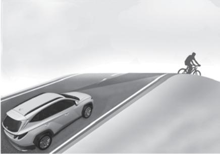
La asistencia de prevención de colisión frontal puede no detectar otros vehículos, vehículos de dos ruedas con motor, peatones o ciclistas por delante al subir o bajar por carreteras en pendiente que afecten negativamente al rendimiento de los sensores.
