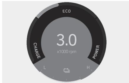
El indicador del sistema híbrido muestra si el estado de la conducción actual está consumiendo combustible de forma eficiente o no.
