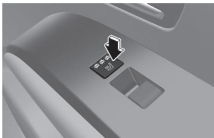
Cuando el motor está funcionando, pulse cualquiera de los interruptores para calentar el asiento del conductor o el asiento del acompañante.
