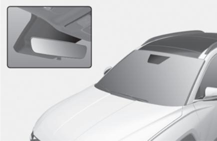
El sensor de lluvia ubicado en el extremo superior del parabrisas detecta la cantidad de lluvia y controla el intervalo del ciclo de pasada.
