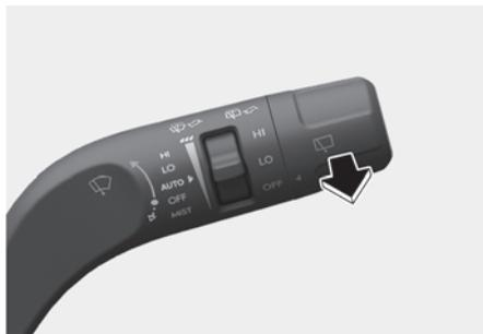
En la posición OFF (O), tire suavemente de la palanca hacia usted para pulverizar líquido lavaparabrisas en el parabrisas y para hacer funcionar los limpiaparabrisas de 1 -3 ciclos. El funcionamiento del pulverizador y del limpiaparabrisas continúa hasta que suelte la palanca. Si el lavaparabrisas no funciona, es posible que necesite añadir líquido lavaparabrisas en el depósito del mismo.
