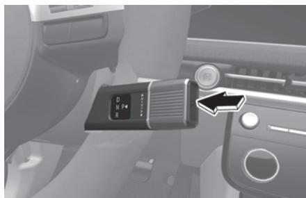
Para cambiar la marcha a P (estacionamiento), pulse el botón P mientras pisa el pedal del freno.
