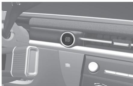
Siempre que se abre la puerta delantera se ilumina el botón Engine Start/Stop (inicio/parada del motor) y se apaga unos segundos después de cerrar la puerta.
