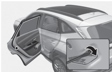
En caso de emergencia, como cuando se descarga la batería, la única manera de bloquear las puertas es utilizando la llave mecánica en la cerradura exterior.
