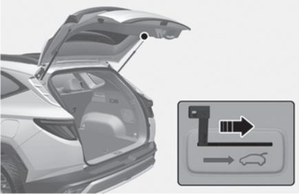
Su vehículo está equipado con una palanca de apertura segura de emergencia del portón trasero colocada en la parte inferior del portón.
