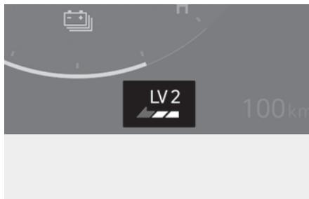
El nivel del frenado regenerativo seleccionado se muestra en el panel de instrumentos.
