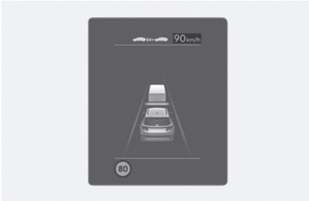
Al conducir a una velocidad superior al límite de velocidad mostrado, el indicador rojo de límite de velocidad parpadeará y sonará el aviso.
