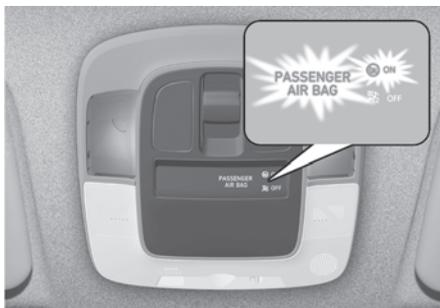
Introduzca la llave o un dispositivo rígido similar en el interruptor ON/OFF del airbag delantero del pasajero y gírelo a la posición ON. El indicador de activación del airbag del acompañante (☺️) se ilumina.
