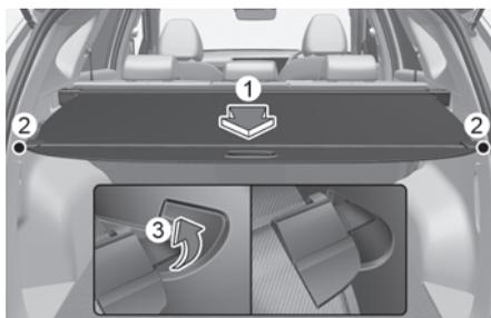
1. Tire de la pantalla de seguridad de la carga hacia la parte trasera del vehículo con la manilla (1).
