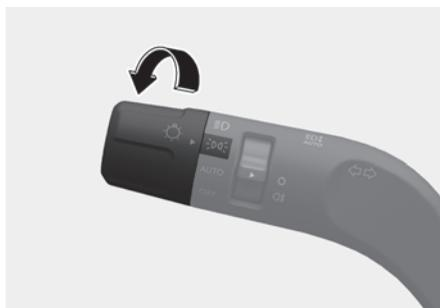
La luz de posición, la luz de la matrícula y la luz del panel de instrumentos se encienden.
