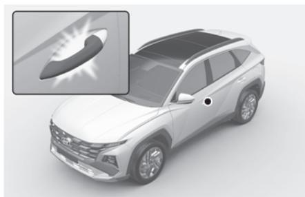
El sistema de bienvenida ayuda a mantener visible al conductor encendiendo las luces del vehículo cuando el conductor se aproxima al vehículo.
