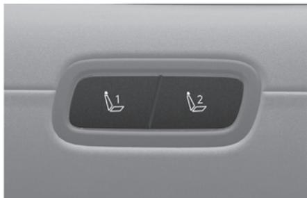
El sistema de memoria integrada del asiento del conductor se proporciona para almacenar y recuperar los ajustes de memoria siguientes con un simple accionamiento del botón.
