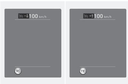
Si el límite de velocidad de la carretera cambia durante el funcionamiento de la asistencia de límite de velocidad manual o del control de crucero inteligente, se muestra una flecha en el sentido hacia arriba o hacia abajo para informar al conductor de que es necesario cambiar la velocidad fijada. En este momento, el conductor puede cambiar la velocidad fijada de acuerdo con el límite de velocidad utilizando el interruptor + o - en el volante.
