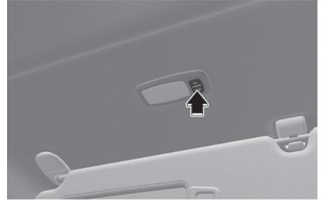
Pulse el interruptor para encender o apagar la luz.
