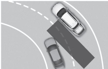
Es posible que la asistencia de prevención de colisión en punto ciego no se accione correctamente al conducir por una carretera con curvas. Es posible que la función no detecte el vehículo que está en el carril contiguo. Preste siempre atención a la carretera y a las condiciones de la conducción.
