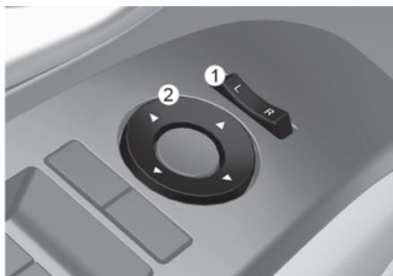
1. Mueva la palanca (1) a la izquierda (L) o a la derecha (R) para seleccionar el espejo retrovisor que desee ajustar.
