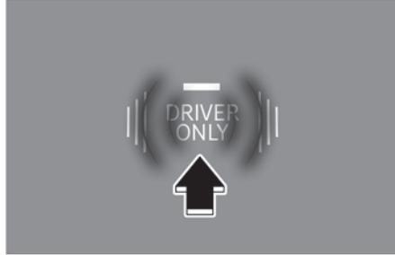
Si presiona el botón de **DRIVER ONLY** (luz indicadora ENCENDIDA), la mayoría del flujo de aire se dirigirá hacia el asiento del conductor.
