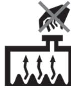
No retire nunca el tapón del refrigerante del motor ni el tapón de drenaje mientras el motor y el radiador estén calientes.
