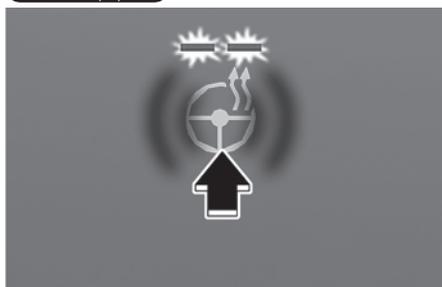
Con el botón ENGINE START/STOP (inicio/parada del motor) en la posición ON o con el motor en marcha, pulse el botón del volante calefactado para calentar el volante.
