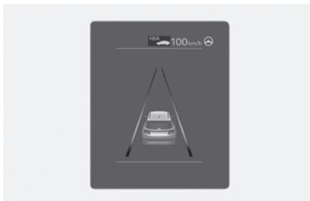
1. Indicador de asistencia de conducción en autopista, si hay un vehículo que le precede y se muestra el nivel de distancia seleccionado.
