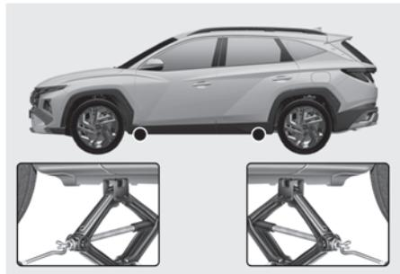
7. Sitúe el gato en la posición designada para el mismo debajo del bastidor y lo más cerca posible del neumático que va a cambiar. Las posiciones para el gato son placas soldadas al bastidor con dos muescas. No coloque el gato en ninguna otra posición ni en ninguna otra parte del vehículo. De lo contrario, se podría dañar la moldura de sellado u otras piezas del vehículo.
