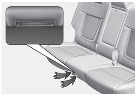
El conducto de refrigeración de la batería híbrida está ubicado en la parte central de los asientos traseros. El conducto de refrigeración enfría la batería híbrida. Cuando el conducto de refrigeración de la batería híbrida está bloqueado, la batería híbrida podría sobrecalentarse.
