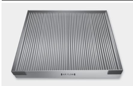
Coloque un filtro de aire del habitáculo nuevo en el sentido correcto con el símbolo de la flecha (↓) orientado hacia abajo para evitar el ruido e incrementar la efectividad.
