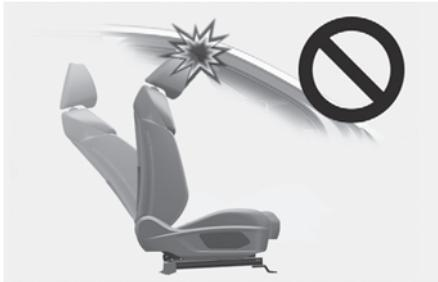
Si inclina el respaldo hacia delante con el reposacabezas y el cojín del asiento elevados, el reposacabezas podría golpear el parasol u otras partes del vehículo.
