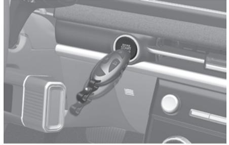
Si la pila de la llave inteligente tiene poca potencia o si la llave inteligente no funciona correctamente, el vehículo puede ponerse en marcha pulsando el botón Engine Start/Stop (inicio/parada del motor) con la llave inteligente en la dirección mostrada en la figura de arriba.
