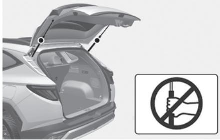
No se agarre o sujete en ningún momento las varillas de apoyo del portón trasero. Pueden producirse daños en las varillas de apoyo del portón trasero. La deformación de las varillas de soporte del portón trasero puede causar daños en el vehículo y provocar lesiones personales.
