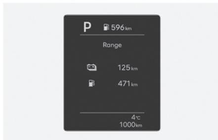
La autonomía es la distancia estimada que el vehículo puede recorrer con el combustible restante en el depósito de combustible (gasolina) y la batería de alta tensión (híbrida) (eléctrica).
