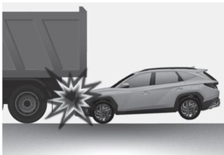
Normalmente, los conductores frenan con mucha fuerza justo antes del impacto. Estas frenadas fuertes bajan la parte delantera del vehículo provocando que "conduzca" por debajo de un vehículo con una mayor holgura con el suelo. Los airbags podrían no inflarse en estas situaciones de "infra-conducción" porque las fuerzas de deceleración que se detectan en los sensores podrían verse muy reducidas en dichas colisiones de "infra conducción".
